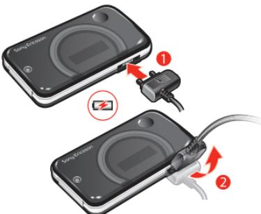
1 Подсоедините зарядное устройство к телефону. Для полной зарядки аккумулятора требуется примерно 2,5 часа. Нажмите любую клавишу для включения экрана.
