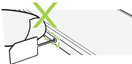
3. Нажмите кончиком инструмента внутрь отверстия до упора, чтобы выдвинуть лоток, а затем вытяните лоток наружу.
