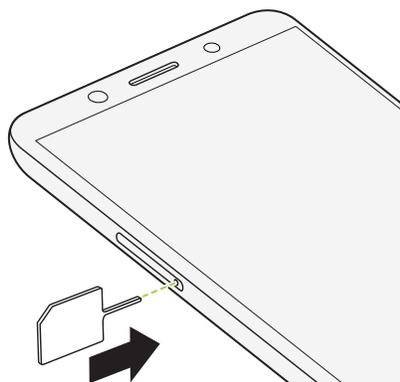
При вставке инструмента для выдвигания лотка в соответствующее отверстие не блокируйте лоток, чтобы избежать повреждения выдвигающего механизма внутри слота.
