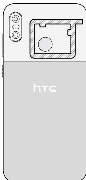
Убедитесь, что область NFC (заштрихованная часть) HTC U12 life и область NFC второго телефона расположены близко друг к другу. Попробуйте слегка перемещать телефоны до тех пор, пока не будет установлено соединение.
